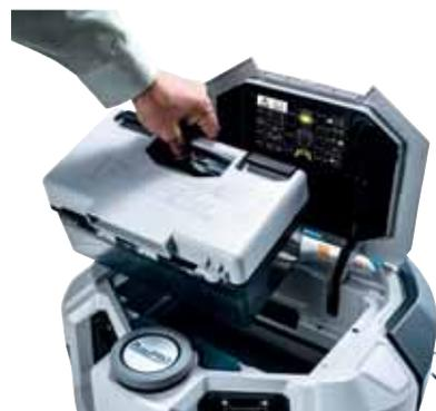
Staubsaammelbehälter mit 3,0 l Fassungsvermögen lässt sich zur Reinigung leicht herausnehmen. Ausgestattet mit einem Filterelement. Kleine Schmutzpartikel gelangen durch die Vakuumanlage in den oberen Teil des Behälters. Große Schmutzpartikel werden im unteren Teil des Behälters gesammelt.
